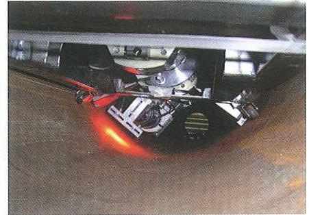
Instrumentation ELIOTE à l'intérieur du tube.
