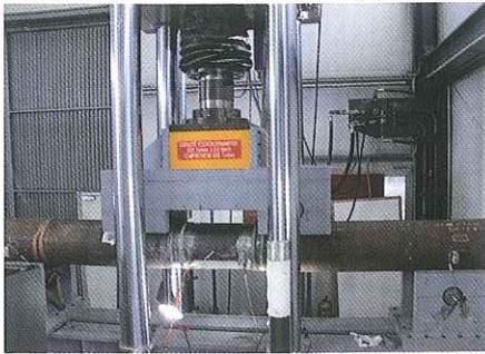
Tube en test sur machine EDF de flexion quatre points.
