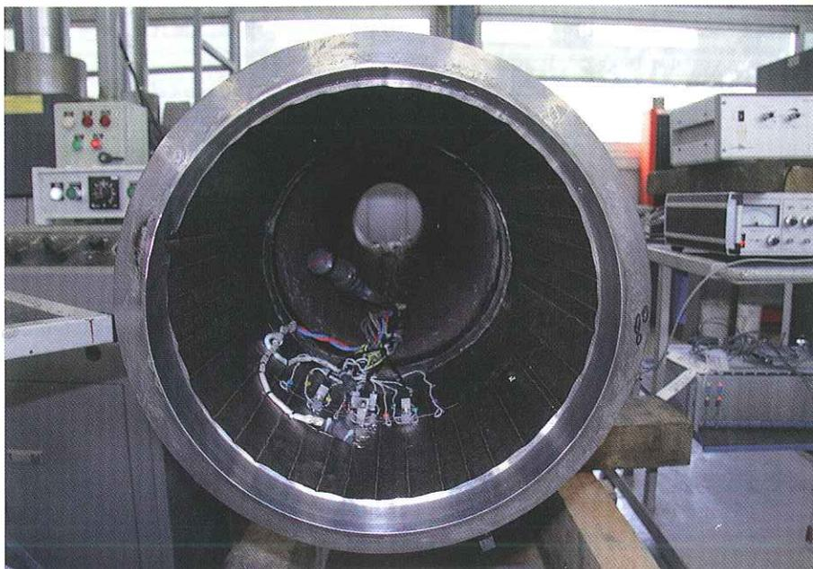
Vue du tube avec l'instrumentation traditionnelle.
