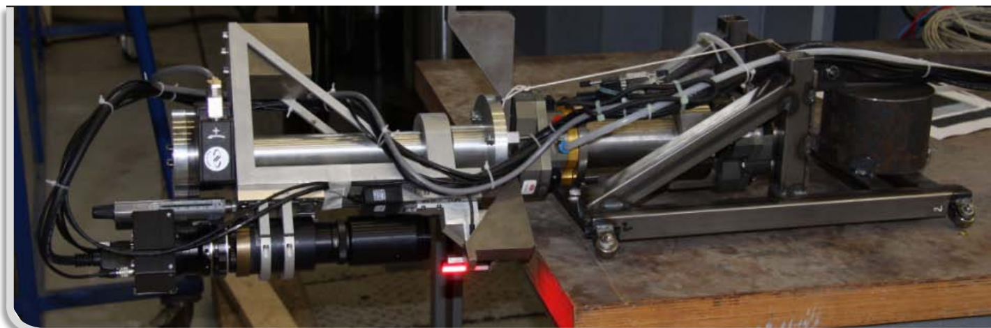
ELIOTE associe l'usage d'une caméra linéaire haute définition, d'un objectif, de motorisations micrométriques et d'un miroir.
