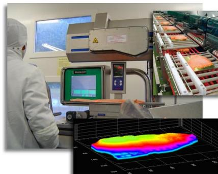
Le système SCANLINE permet de réaliser le profil de pièces en relief, grâce à l'association d'une caméra numérique et d'une ligne LASER, avec une grande précision. Vous avez la possibilité d'effectuer la mesure en hauteur et en largeur de vos objets sans aucun contact.
