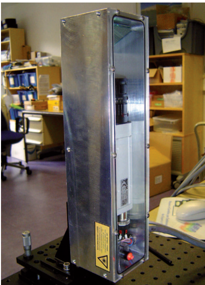
La caméra 3D Ranger est installée dans un boîtier extrêmement compact
